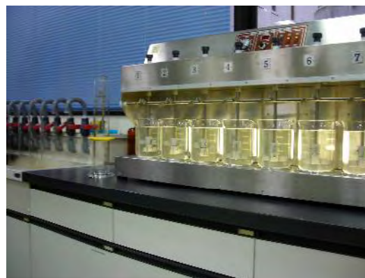
浄水処理状況確認試験
