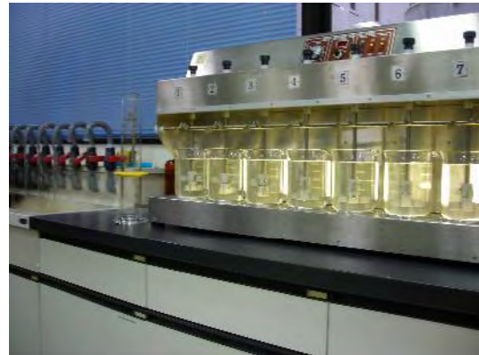
浄水処理状況確認試験
