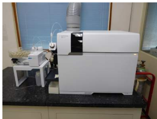
誘導結合プラズマ質量分析計 (金属類検査用)
