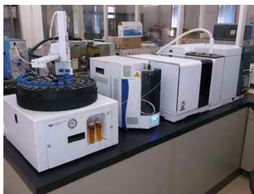
ガスクロマトグラフ質量分析計 (揮発性有機化合物検査用)
