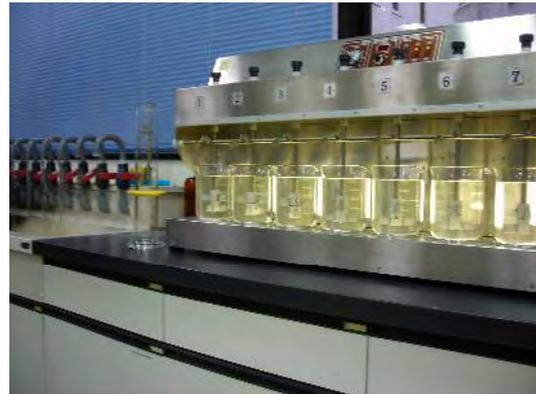
浄水処理状況確認試験
